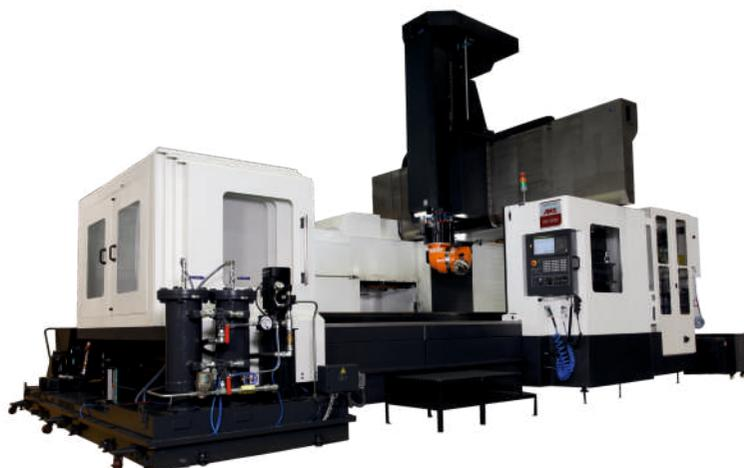
Станки этой серии подходят для обработки крупногабаритных изделий массой до 10 тонн и применяются в автомобильной, аэрокосмической, нефтяной, горнодобывающей и энергетической промышленности.
