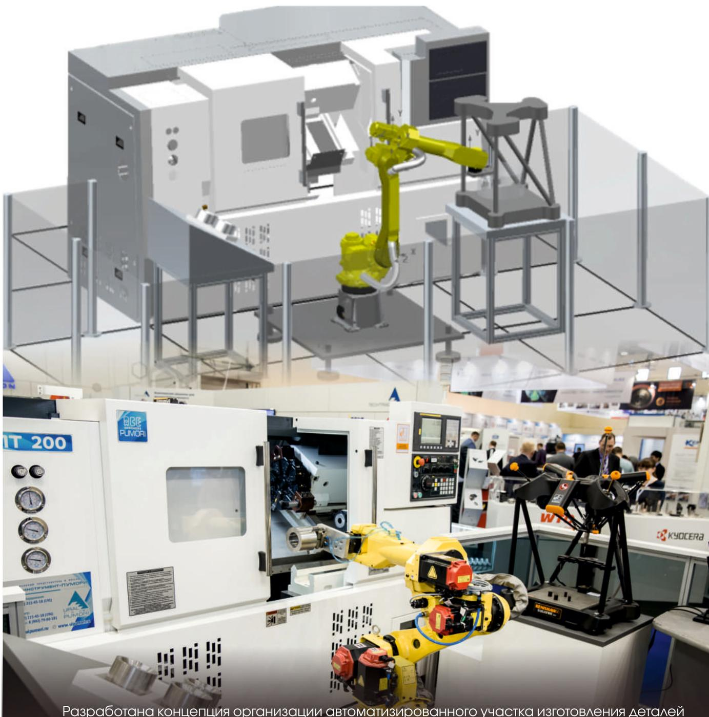
Разработана концепция организации автоматизированного участка изготовления деталей с промежуточным контролем ответственных поверхностей при помощи Equator:
